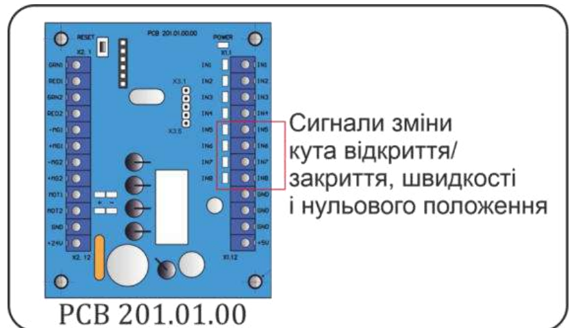
Рис. 17 – Сигнали зміни кута повороту на контролері PCB 201
