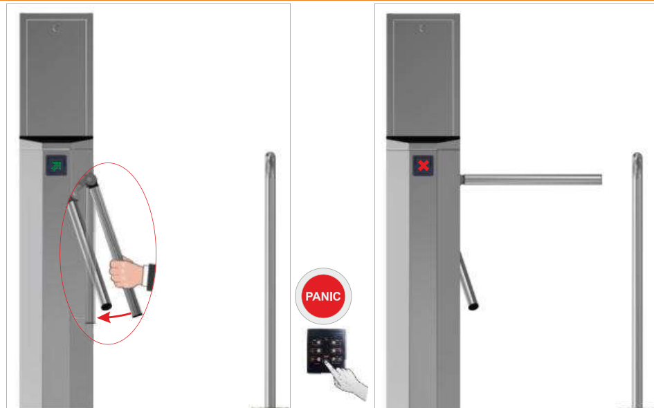
а) Положення планки в режимі «ПАНІКА» перед відновленням
