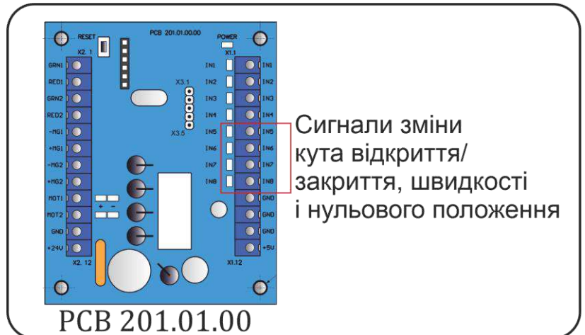
Рис. 19 – Сигнали зміни кута повороту на контролері РСВ 201
